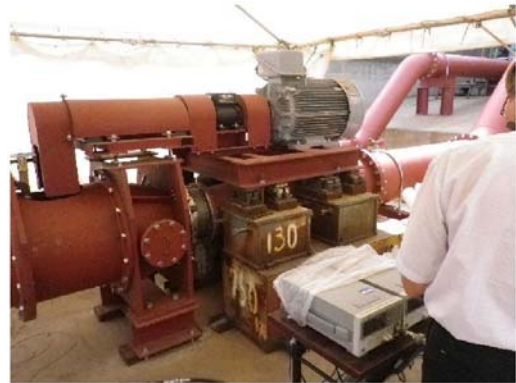
写真-2 試作水車（40kW）による特性試験
