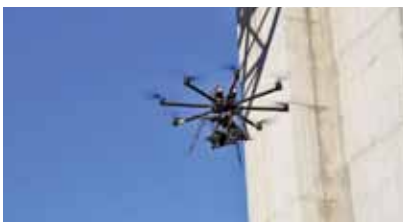
写真技術を応用した点検調査（当社保有UAV）
