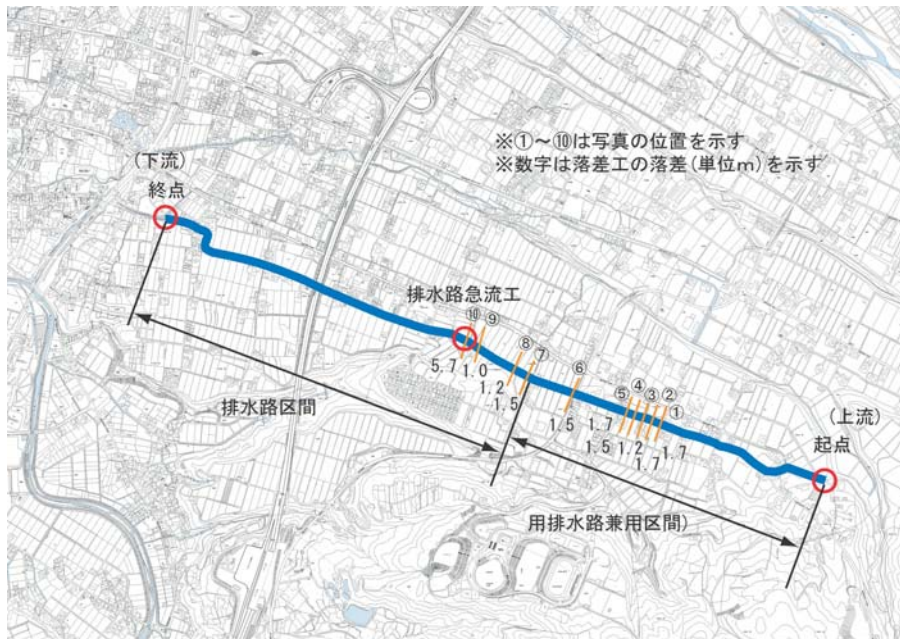
図Ⅱ-3（1） 荒井用水路と荒井排水路急流工の位置
