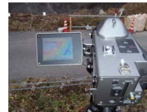
写真-2 熱赤外線撮影装置
